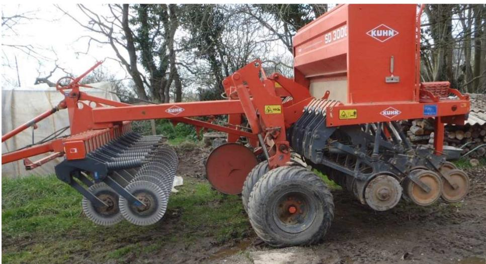
Figure 2 : semoir de semis direct Khun avec disques ouvreurs et disques semeurs
