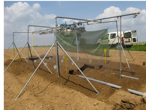
Fig. 4. Simulateur de pluie
