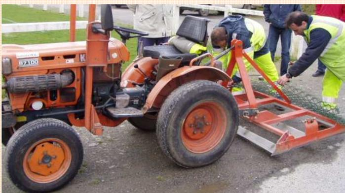
**dés herbeurs mécaniques** (de style sabots rotatifs ou châssis de piste notamment)
