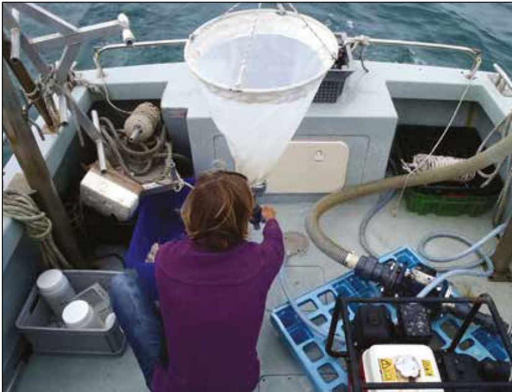
Figure 168 : Préparation du système de filtration d'eau de mer à l'aide d'une pompe et d'un filet à plancton pour la pêche de larves d'huîtres plates (projet PERLE ; Duchêne et al., 2016).
